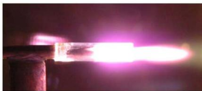
Рис.13. Иницированный трубчатым вибратором глубоко подкритический СВЧ-разряд в высокоскоростной струе воздуха
