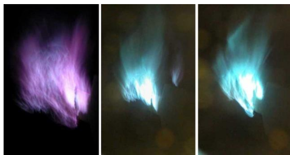
Рис.20 Поджиг сверхзвуковой затопленной струи пропан-воздушной смеси подкритическим СВЧ-разрядом с объемно-развитой стримерно-шнуровой структурой
