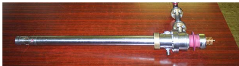
Рис. 6. Схема и фото двухрезонаторного гирумножителя с самовозбуждающейся входной секцией.
