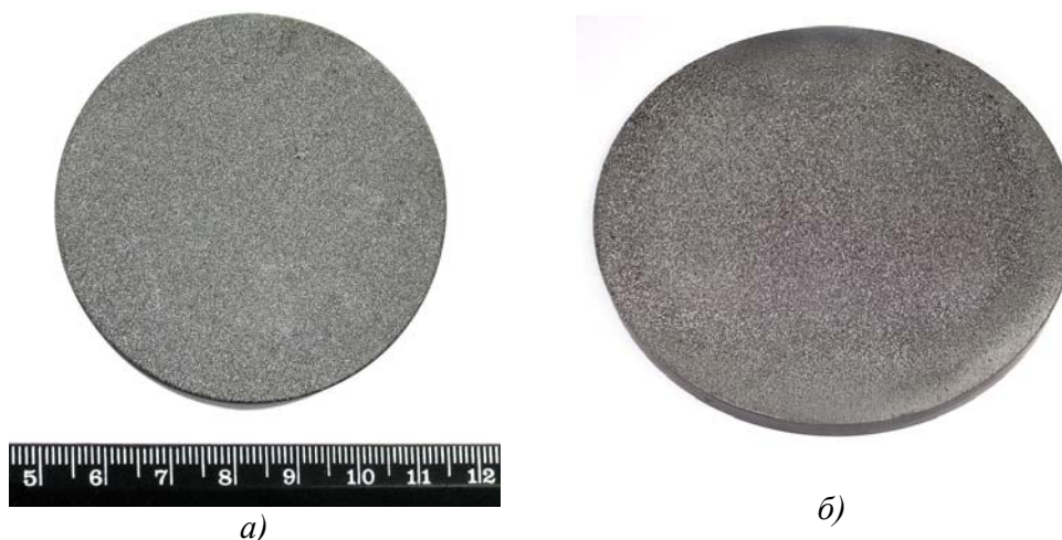
Рис.7. Общий вид поликристаллических алмазных пластин толщиной 0,13 мм и диаметром 60 мм (а); толщиной 0,65 мм и диаметром 75 мм (б) на кремниевых подложках.
