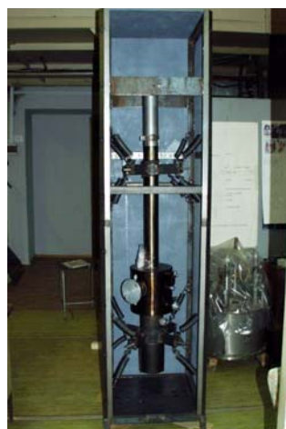
Рис. 1. Сверхпроводящий «сухой» (без жидкого гелия) магнит на поле 12 Тл и гиротрон на частоту 0,3 ТГц с встроенным квазиоптическим преобразователем рабочей моды TE_{22,8} в гауссов волновой пучок.
